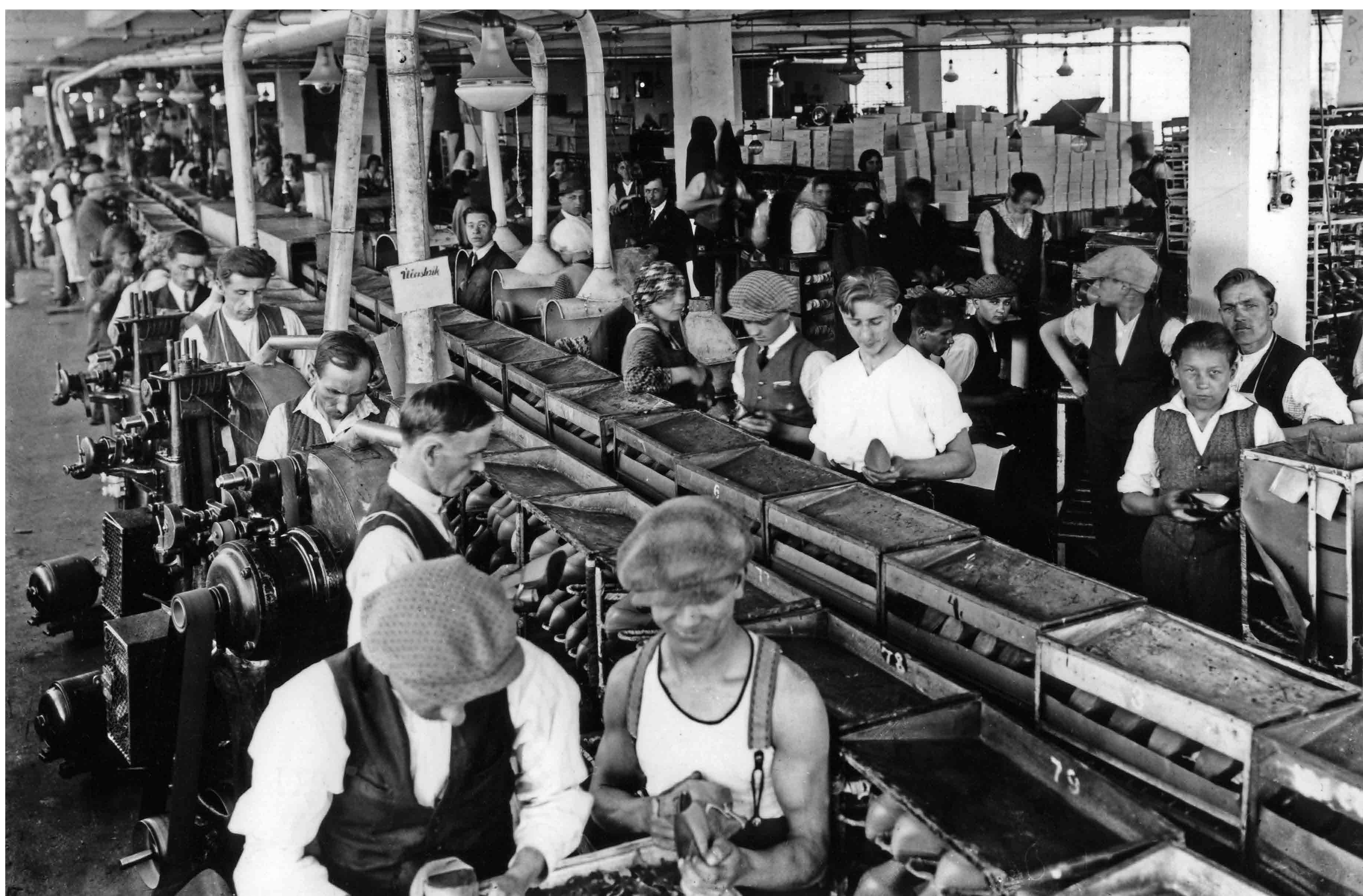
V Baťově továrně ve Zlíně se od roku 1927 při výrobě obuvi využívala technologie pohyblivých pásů (1933)
